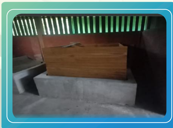
Figura 4. Cajones de fermentación de cacao construidas.
