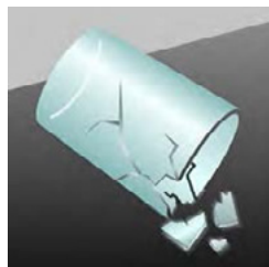
ลักษณะการแตกของแก้ว HS Full Surface Ion Toughening
