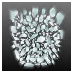
ลักษณะการแตกของแก้ว Full Surface Physical Toughened
