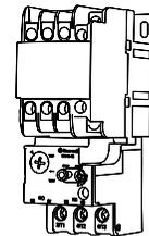
Montaje en contactor
