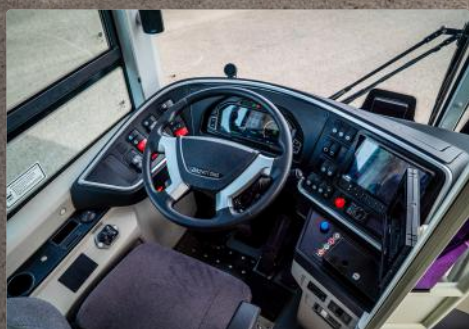
↑ Consola digital, visión por cámaras, aire acondicionado, autodiagnóstico y máxima ergonomía para el conductor.
