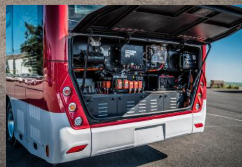
↑ Motor JJE con 200 kW y 2.800 Nm, ideal para cerros y pendientes. Energía limpia con baterías CATL IP68.
