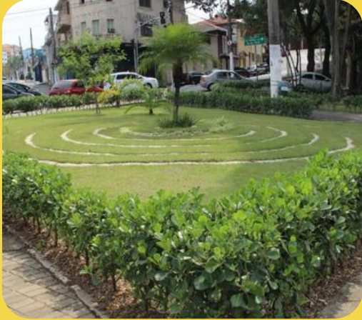
Ejemplo de jardines de lluvia en la ciudad. Imagen: Prefeitura de São Paulo.
