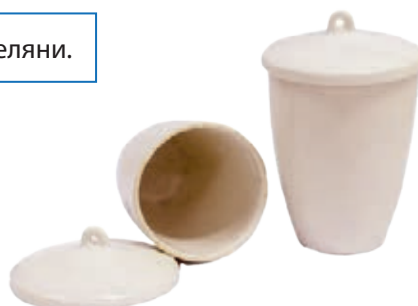
Порцеляновий тигель із кришкою, у якому можна нагрівати й прожарювати тверді речовини
