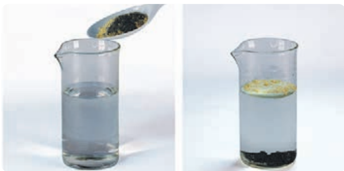
Мал. 13.2. Відстоювання ґрунтується на тому, що речовини з меншою густиною спливають на поверхню, а з більшою — осідають на дно посудини
