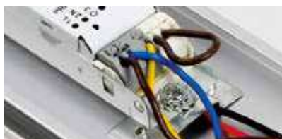
Screwless terminal block. Loop-in/loop-out wiring with 5x2.5 mm cable. Bornier sans vis. Câblage entrée/sortie en boucle en 5x2,5 mm.
