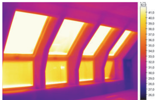
Abb. 8: Innenaufnahme von Dachflächenfenstern bei der Luftdichtheitsmessung (Startthermogramm). Bild: BlowerDoor GmbH
