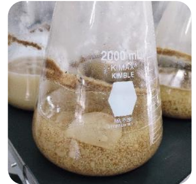
Figura 5. Biorreactor con potencial uso en la producción de hongos para la micorremediación.
