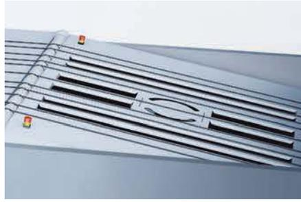
Автоматический/двухкассетный загрузчик Auto/Dual Cassette Loader (ACL/DCL) со встроенным поворотным столом позволяет автоматизировать загрузку пластин в Suprasetter.
