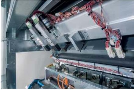
Встроенная система пробивки штифтовых отверстий работает с максимальной точностью приводки. Это сокращает время переналадки, особенно при повторных заданиях.
