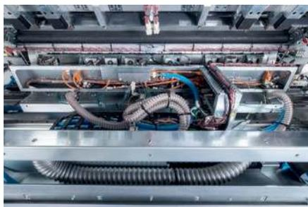
Система отсоса и противопылевых фильтров Debris Removal System удаляет пыль и свободные частицы, как только они появляются.
