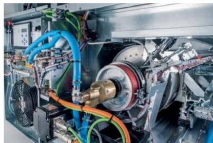
Система терморегулирования стандартизирует условия экспонирования для пластин.
