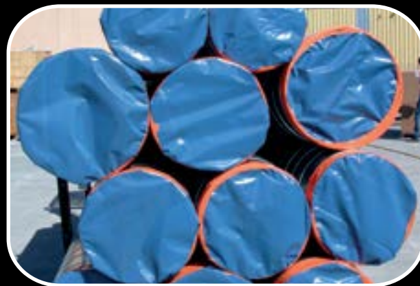
Gaines nettoyées bouchonnées
