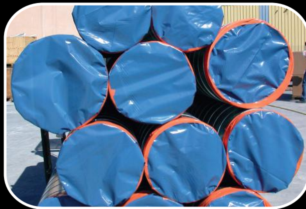
Gaines nettoyées bouchonnées
