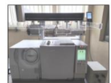
FIGURA N°2. Cromatografía de gases. SHIMADZU GC-2010 PLUS. Automuestreador SHIMADZU AOC-4000. Detector de espectrometría de masas, SHIMADZU GCMS-QP210 Ultra.
