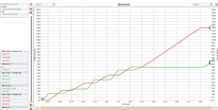
Fig. 3. Gráfico semanal de la potencia reactiva trifásica antes de la compensación (color verde: inductiva; color rojo: capacitiva)
