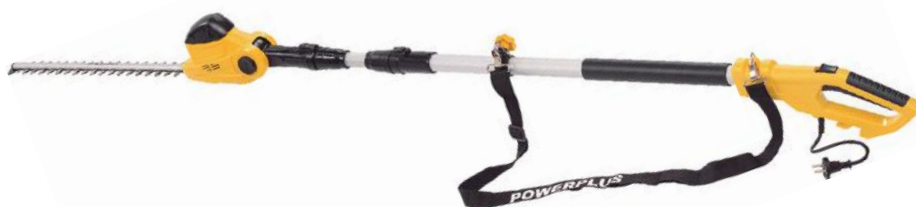
CORTASETOS ELÉCTRICO TELESCÓPICO 23004562 Potencia 550 W, cuchilla de 55 cm de 20 mm entre dientes. Mango telescópico de 2,35 a 2,80 m.
