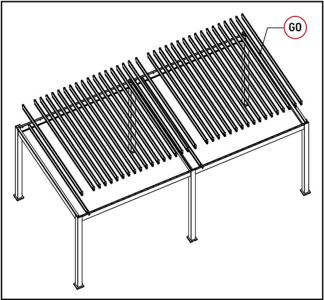
Setzen Sie die anderen Lamellen ein und verschließen Sie die Endkappen.
