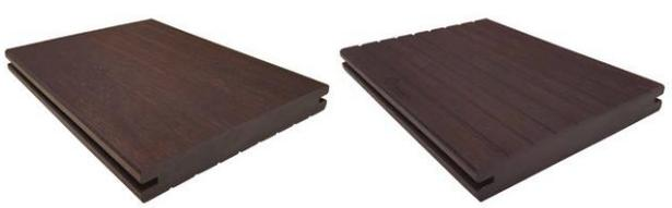
El proceso de fusión patentado por dassoXTR® extrae los azúcares y almidones de las fibras de bambú y los reemplaza por resinas fenólicas. Luego, las fibras impregnadas se comprimen para crear Fused Bamboo®: muy duro, denso y duradero contra bacterias, hongos y otros microorganismos.
