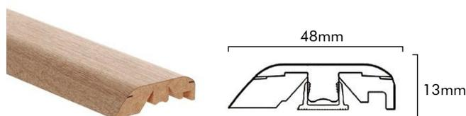
Perfil multifuncional patentado. Largo 2150 mm. Se corta según la forma deseada con el cúter incluido. Para conectar dos suelos con alturas distintas o con la misma altura. Para acabar el suelo junto a la pared o ventana.
