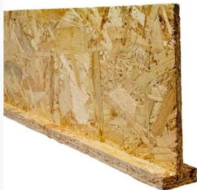
La poutre en T, avec une âme en multiplex de 6 mm et un support OSB de 18 x 58 mm, renforce les chevrons abîmés, réaligne la charpente et optimise l'espace pour l'isolation.
