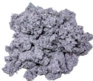
Isolant écologique issu du papier recyclé, la ouate de cellulose offre une isolation thermique et acoustique performante, idéale pour combles et rénovations.
