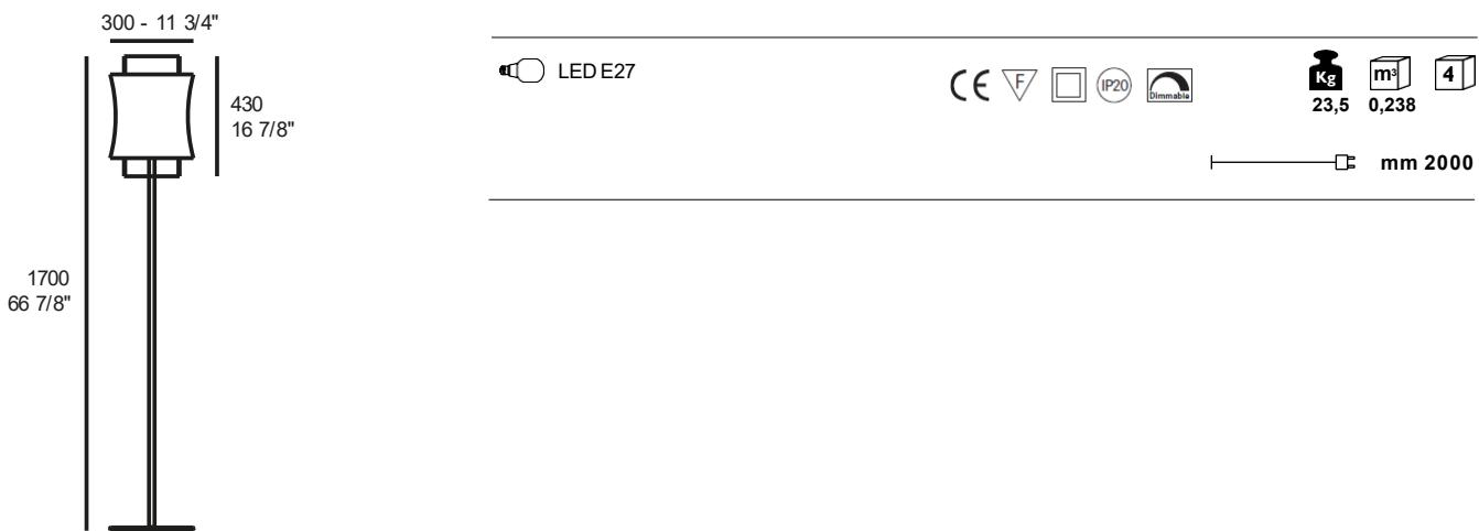
diffusore interno in cristallo trasparente, diffusore esterno in metallo, struttura cromata, cavo in tessuto nero, dimmer su cavo
