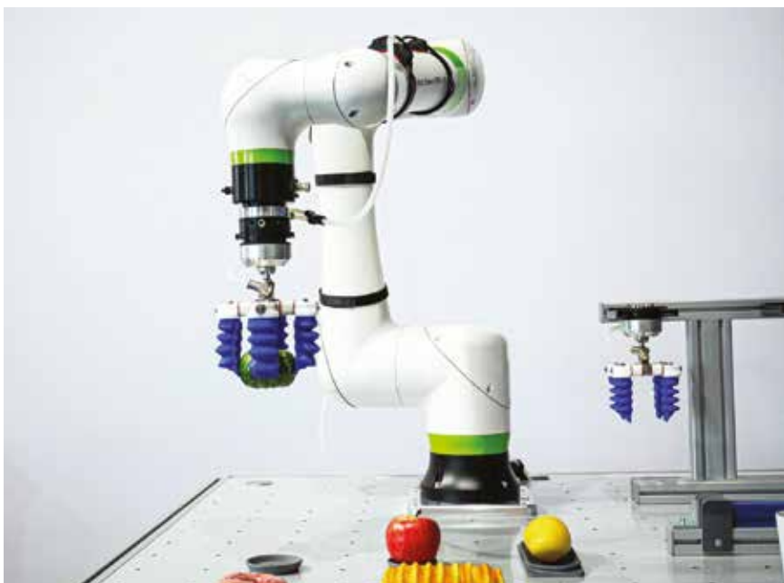
Der pneumatische Fingergreifer mGrip bewegt empfindliche Werkstücke besonders sensibel und lässt sich einfach steuern.
