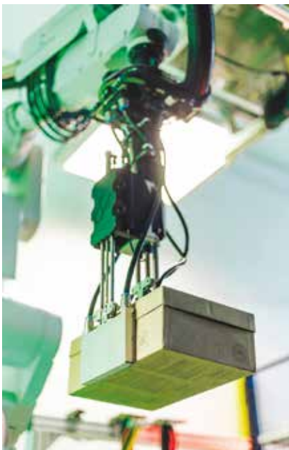
Die automatisierte Handhabung von Schuhkartons zählt zu den größten Herausforderungen in der Logistik. Der Shoebox Picker ermöglicht die Automatisierung dieses fehlenden Bausteins in der Fashion Logistik.
