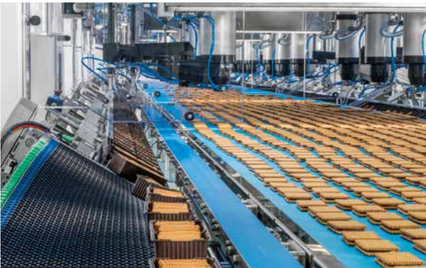
3D-Scanner (oberer Bildbereich) überprüfen neben Form und Lage auch die Höhe der Kekse.
