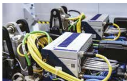
Unterschiedliche Teile gleichzeitig mit nur einem System zu handhaben, ermöglicht das Mini-Kompaktterminal SCTMi. Es bündelt mehrere Vakuum-Erzeuger in einer kompakten Einheit.
