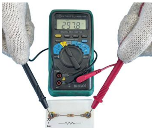
รูปที่ 2.23 การวัดค่าความต้านทาน ที่มา : จิรโรจน์ เลิศชนเปี่ยมสุข. 2565
