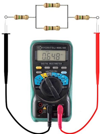
รูปที่ 2.26 การวัดค่าความต้านทานรวมของการต่อวงจรแบบผสม ที่มา : จิรโรจน์ เลิศชนเปี่ยมสุข. 2565
