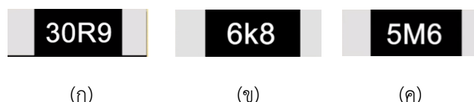
รูปที่ 2.13 การอ่านค่าความต้านทานแบบใช้ตัวเลขร่วมกับตัวอักษร
