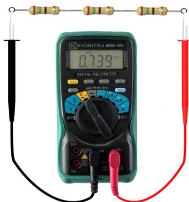
รูปที่ 2.24 การวัดค่าความต้านทานรวมของการต่อวงจรแบบอนุกรม ที่มา : จิรโรจน์ เลิศชนเปี่ยมสุข. 2565
