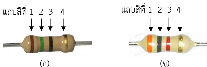
รูปที่ 2.14 การอ่านค่าตัวต้านทานแบบรหัส 4 แถบสี
