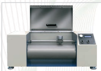
DIN耐磨试验机
