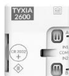
Tyxia 2600 Émetteur sans fil 2 voies Pour créer un interrupteur variateur
