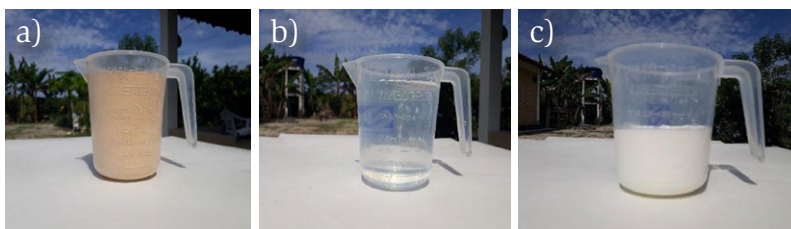
Figura 3. Componentes utilizados para a produção da tinta ecológica na proporção 1;1;1/2 de solo (a), água (b) e cola (c). Fonte: Autores (2021).
