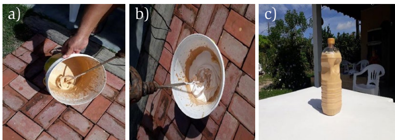
Figura 4. Etapas da produção da tinta ecológica, mistura do solo e água (a), adição de cola (b) e tinta pronta (c).Fonte: Autores (2021).
