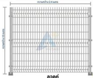
แผง 1.53ม. x 2.40ม. น้ำหนัก 20.00 กก. เสา 60x60 มม. สูง 1.60ม. น้ำหนัก 4.76 กก.
