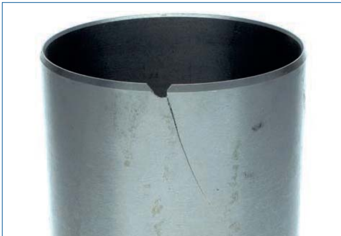
Тріщина, яка утворилася після падіння втулки на підлогу
