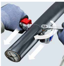
Taglio a trazione con l'ausilio di una leva a cricchetto
