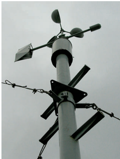
Haizearen indarra eta noranzkoa neurtzeko, besteak beste anemometro hau dago Igeldoko behatokiaren dorrean.
