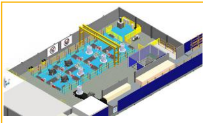
GRÚA PÓRTICO CON DOBLE GANCHO DE 35 Y 15 TON
