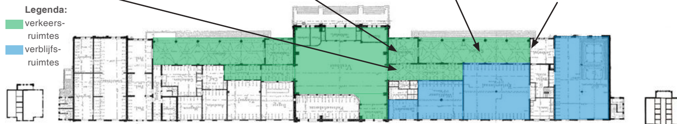
Afb. 4.11: Plattegrond met verblijfs- en verkeersruimtes voor reizigers
