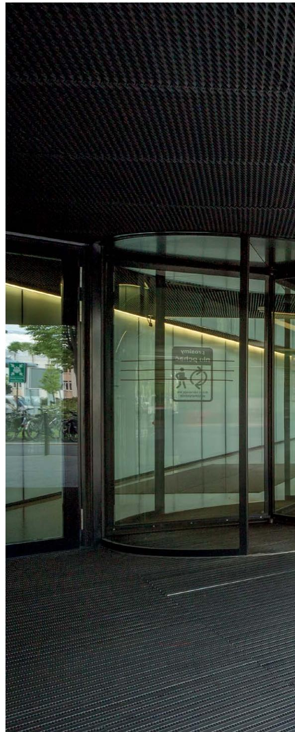
Las mallas desplegadas a diferencia de las mallas electro soldadas o tejidas, se fabrican a partir de una sola plancha, siendo un solo elemento, pudiendo fabricarse en diferentes espesores, materialidades, aberturas, texturas y colores, proporcionando una infinita gama de productos para diferentes aplicaciones, como cielos, fachadas o revestimientos interiores.
