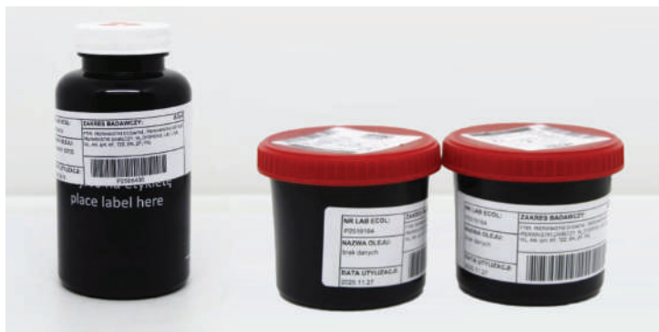
Ilustracja 5. Przykładowe pojemniki do pobierania próbek oleju stosowane w badaniach diagnostycznych.
