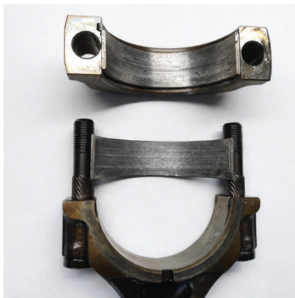
Ilustracja 4. Elementy tożyskowania panewki) po demontażu – widoczne ślady pracy na powierzchniach ślizgowych.
