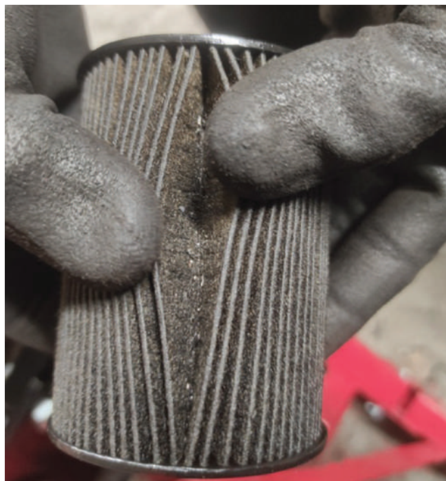
Ilustracja 3. Filtr oleju z nagromadzonymi zanieczyszczeniami pochodzącymi z procesów tarcowych elementów silnika.
