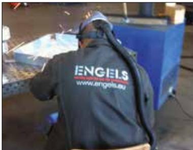
**Aluminiumschweißen. Viele unserer Produkte werden wegen des geringen Gewichts und der guten Korrosionsbeständigkeit aus Aluminium hergestellt.**
