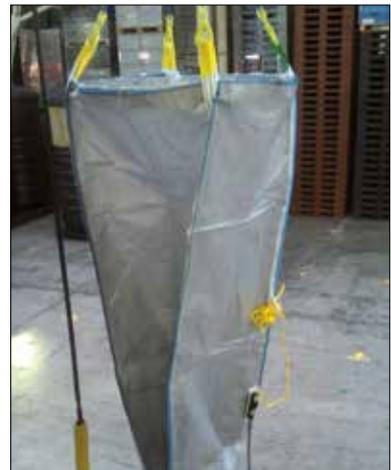
Die Schnur des Standardtragesacks hat einen doppelten Verschluss. Mithilfe dieser Schnur kann der Tragesack geleert werden. Der Verschluss und die Schnur sind seitlich am Tragesack befestigt.
