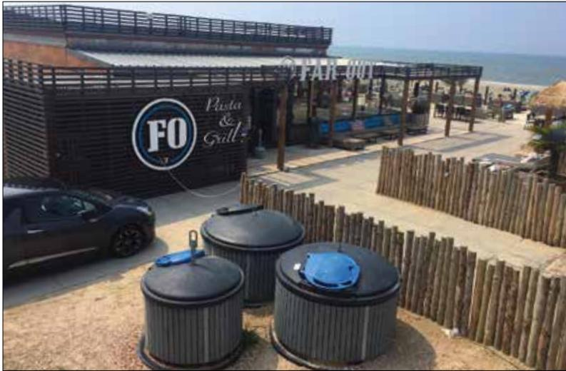
Teilbare Container am Beachclub Far Out in Zandvoort (Niederlande). Nach der Sommersaison müssen die Strandpavillons alle abgeschlagen werden, damit die Strände leer sind. Bei diesem Tiërso-Typ kann das Oberteil abgenommen werden und der unterirdische Teil wird mit einer Abdeckplatte abgedeckt.
