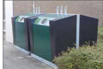
Die Öffnungen für den Glas- bzw. Papiereinwurf sind passgenau mit einer Einwurföffnung aus Kunststoff oder Edelstahl verkleidet und mit einer Gummi- oder Edelstahlklappe verschlossen.
