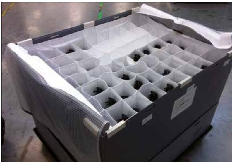
*Versandeinheit mit Textilinterieur und transparentem Staubschutz.*
