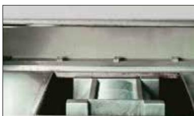
**Nachdem das Produkt abgekühlt ist, wird die Form wieder nach unten gezogen und die Platte wird aus der Maschine genommen.**
