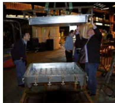
**Mit dem Kunden an der Rotationsgussmaschine, um die Form in Aktion zu sehen. Ein erstes Modell wurde bereits mitgenommen, um es in der Regenwurmzuchtanlage mit den Sieb- und Kippmaschinen zu testen.**
