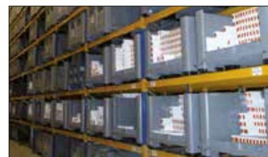
**Auch eine Möglichkeit: Durch das Ausfräsen der Frontplatten entstehen aus Palettenboxen Kunststoffpaletten mit hochstehenden Rändern.**
