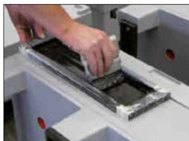
Das Sieb wird auf den Behälter gedrückt und mit einer Druckbewegung wird die Farbe auf den Behälter übertragen.
