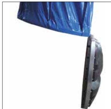
1-Hakensystem mit Anschlagmechanismus zum Öffnen des Bodens.
