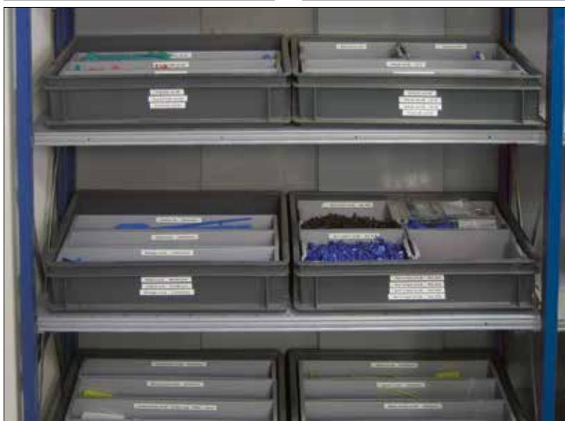
*Die Verwendung von Einsatzbehältern bietet pro Regalboden mehr Lagermöglichkeiten. Grundfläche pro Regalboden: 600 x 400 mm.*
