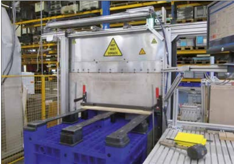
*Kleine Serien spiegelschweißen wir manuell, große Serien maschinell. So funktioniert es: Die Teile werden gegen eine heiße Platte gedrückt und anschließend aneinander. Die Schweißnaht ist stabiler als der umgebende Kunststoff.*
