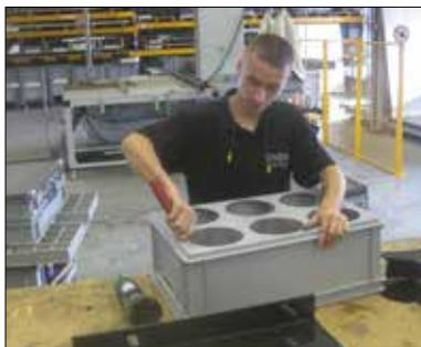
**Hier werden Öffnungen in den Boden eines Behälters gefräst. Dieser wird anschließend auf einen hohen Behälter für Gasflaschen geschweißt.**
