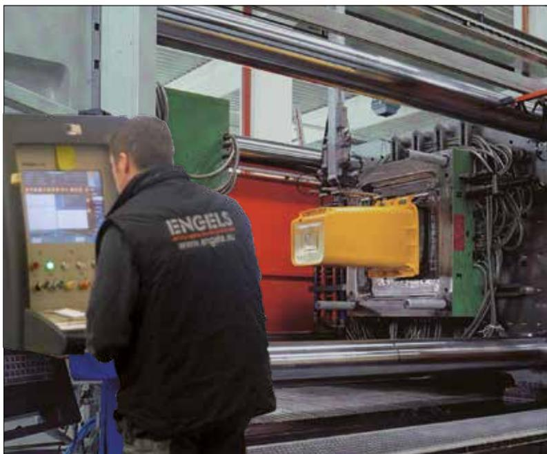
**Spritzgussmaschine für 240-Liter-Container oder Großvolumenbehälter.**
