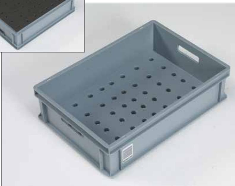
Behälter für pharmazeutische Rohstoffe, für die Lagerung im Hochregallager. Sonderausführungen: Euronorm-Innenmaß 605 x 405 mm, doppelwandiger Schwerlastboden mit Auslauföffnungen für die Sprinkleranlage und zu Reinigungszwecken.
