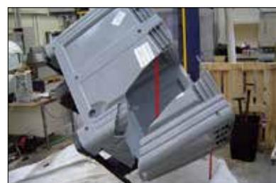
**Ergebnis einer Fallprüfung bei zu hoher Belastung**
