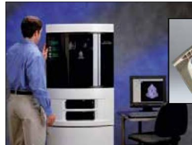
Häufig wird entschieden, ein Eins-zu-Eins-Modell anzufertigen, eine kostspielige Angelegenheit. Zum Glück kann inzwischen mithilfe schneller Prototyping-Maschinen, die über CAD-Programme gesteuert werden, innerhalb weniger Stunden ein Muster angefertigt werden.
