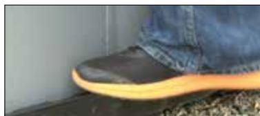
Die Aufsatzwände werden vom Boden gelöst, indem sie mit dem Fuß nach innen gedrückt werden.
