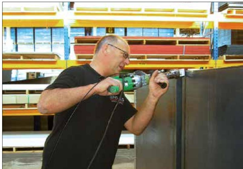
*Schweißen mit einem Extruder. Kunststoff wird in die Naht extrudiert, die Umgebung wird erhitzt.*
