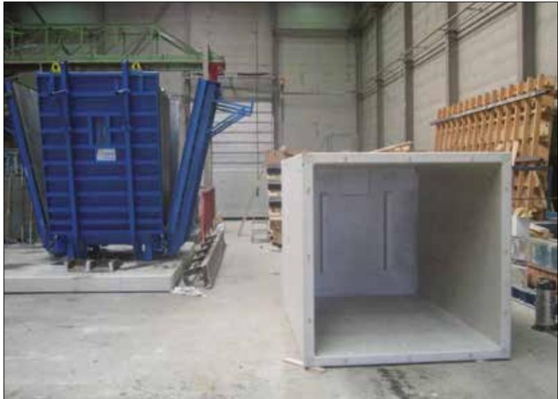
*Wir verwenden immer einen 5000-Liter-Schacht (4000 l auf Anfrage). Die Containerstütze ist in den Boden eingelassen und über die tiefergelegte Öffnung wird mögliches Wasser abgesaugt.*
