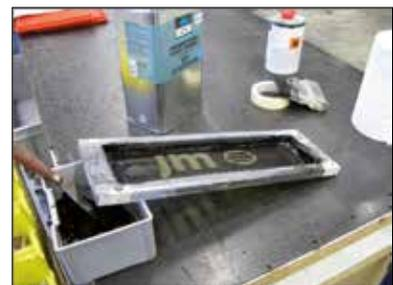
Das Sieb wird sorgfältig gereinigt, damit die Farbe gleichmäßig verteilt werden kann.
