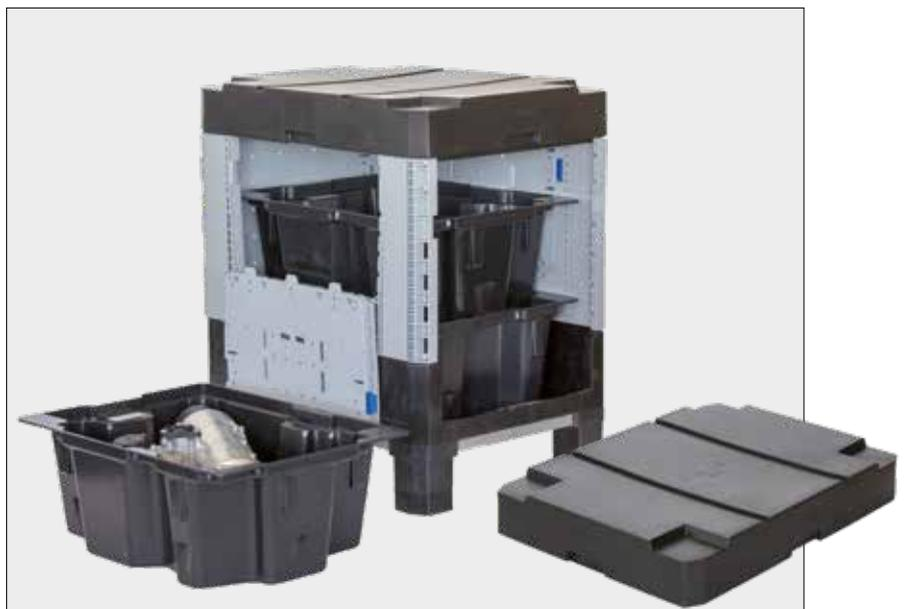
*Transportcontainer für schwere und teure Ölfiltermodule für DAF-LKW. Die Module werden vom Lieferanten aus dem Ersatzteillager häufig direkt an die Montagelinie transportiert. Der Container ist klappbar, was die Hälfte der Transporten spart. Die zu lagernde Ölfiltermodule werden einzeln in vakuumgeformte Produktträger eingelegt. Der im Rotationsgussverfahren hergestellte Deckel ist so konstruiert, dass drei Module in einen Transportcontainer passen.*
