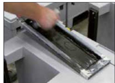
Das Sieb wird vom Behälter abgenommen und die Farbe wird an die Anfangsposition des Siebs zurückgebracht.
