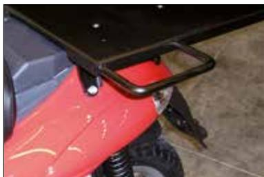
**Boxträger aus Stahl mit Griff, speziell für den Piaggio Liberty entwickelt. Dank des Griffs lässt sich der Motorroller leicht auf den Ständer stellen.**
