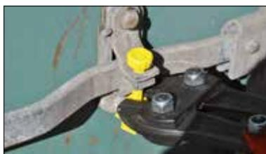
Barriereplomben können nur mit einem Seiten- oder Bolzenschneider entfernt werden.
