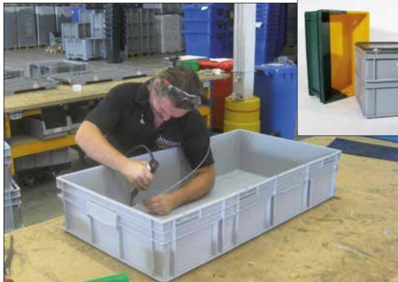
*Schweißen mit einem Föhn, präzise fachmännische Arbeiten. Der Kunststoffdraht wird in der Schweißnaht geschmolzen.*
