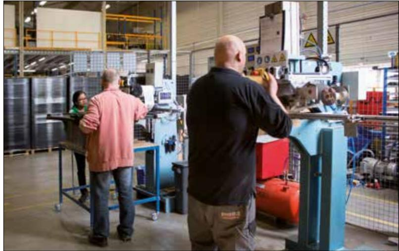
Heißprägemaschinen. Mithilfe eines erhitzten Stempels (ca. 200° Celsius) wird der Aufdruck über ein Farbband in den Behälter gepresst (die Kraft ist von der Oberfläche abhängig, ca. 1000 kg).
