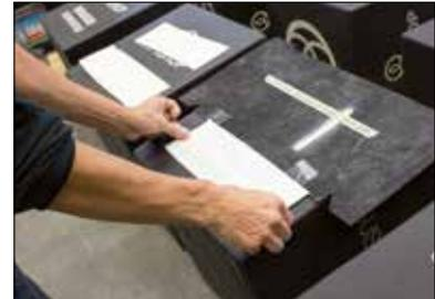
**Die Schablone wird auf den Behälter geklebt.**
