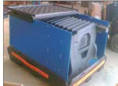
**Paletten mit Aufsatzwänden aus Stegplatten und Deckeln, kombiniert mit einem Schauminterieur, um Zulieferteile für die Automobilindustrie an Ort und Stelle zu halten.**
