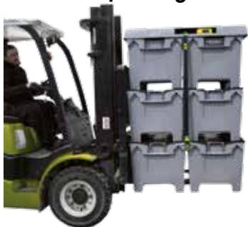
**Die Großvolumenbehälter können in Sets von 6 gestapelt werden und mit einer Deckplatte als Versandeinheit verbunden werden. Siehe Seite 226.**
