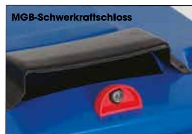
Bei MGB-Schwerkraftschlössern wird der Deckel automatisch entriegelt, wenn der MGB um mehr als 90° gekippt wird. Wenn der Container anschließend wieder abgesetzt wird, wird der Deckel auch wieder automatisch verriegelt.
