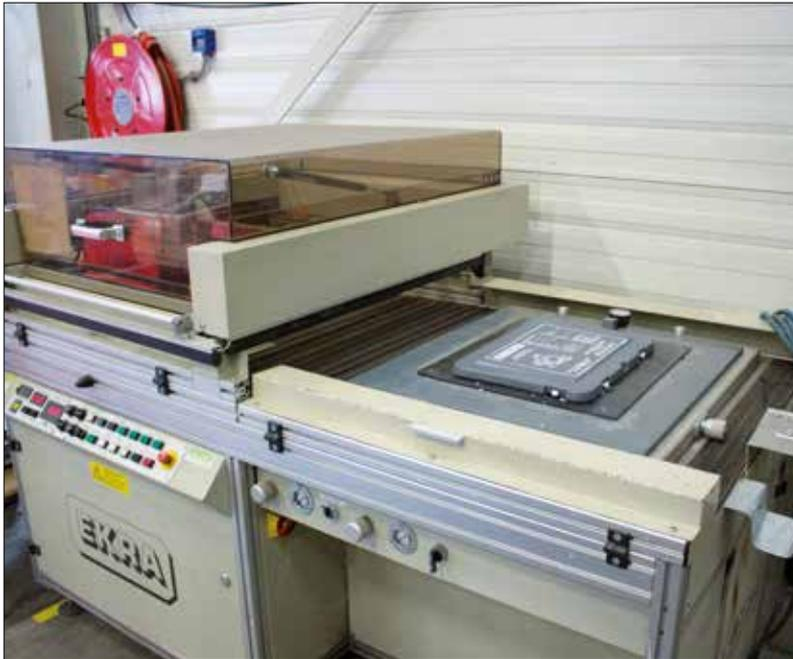
*Maschineller Siebdruck auf Deckeln. Der Deckel wird maschinell unter dem Sieb positioniert und die Farbe wird automatisch gedruckt.*
