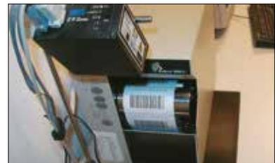
Jeder gedruckte Barcode wird standardmäßig 10 mal gescannt. Bei ungenügender Qualität wird der Drucker automatisch angehalten.
