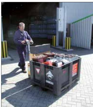
Sie lassen sich dank der drei stabilen Kufen und der geraden Seitenwände leicht kippen und entleeren. Meist mit abnehmbarem Deckel. Ausführung und Aufkleber gemäß ADR. Abmessungen: 1200 x 1000 x 780 mm.
