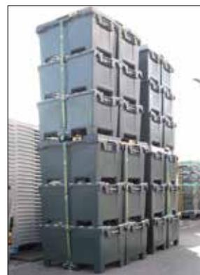
Großvolumenbehälter mit Scharnierdeckeln (ALC) werden vor allem verwendet, um den Inhalt während des Transports vor Diebstahl zu schützen. Die maximale (statische) Stapelbelastung beträgt 450 kg, pro Stück bis 100 kg belastbar.
