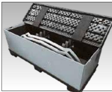
*Aircell-Platten sind hervorragend für die Herstellung von Verpackungen in kleinen Serien geeignet. Eine Arbeit, die wir gerne in unserer eigenen Montageabteilung ausführen.*
