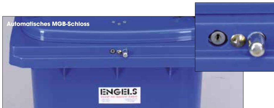
Das automatische Schloss wird geöffnet, wenn der Deckel des Containers bei der Kammaufnahme am Müllwagen hängt. Durch den Druck auf den Stift, wird der Deckel geöffnet. Zum Füllen des Containers hat der Benutzer Zugang über ein Zylinderschloss.
