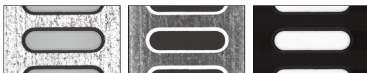
Iluminación de superficie
