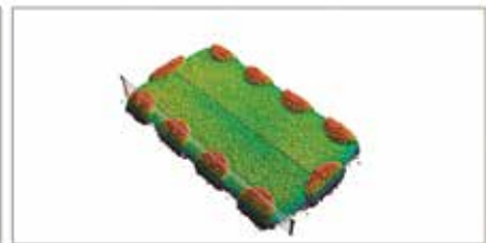
Ejemplo de uso de QVWLI Pro para realizar mediciones de líneas, espacios y espesores de conductores en una tarjeta de circuito impreso
