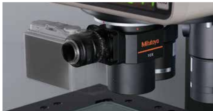
Ejemplo de instalación de la lente de proyección 10X con montura C en PJ-H30
