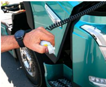
↑ La cabina bascula con eléctricamente con control remoto.
