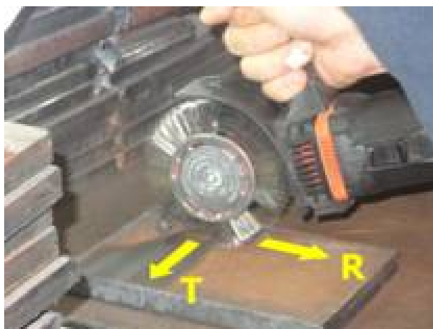
Fig. 2: Escova rotativa com efeito de jato com cerdas ( bristle blasting ). Direções rotacional (R) e progressivo (T) da escova
