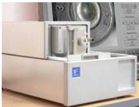
Fig. 6: Scanner óptico de superfícies BS 7 USB do sistema automatizado de identificação balística ARSENAL PAPILLON
