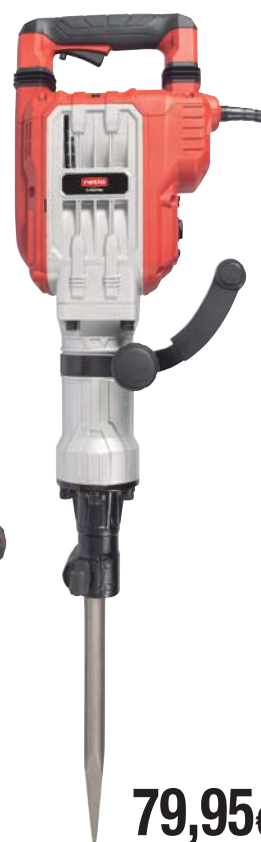
7994X447 Martillo demoledor Ratio R-MD1750 1.750 W. 1900 ipm. Impacto 5 Julios. Peso 15 kg.
