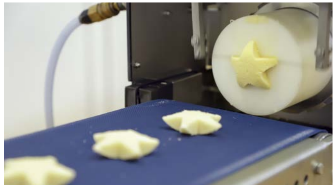
Mit dem Cheese Block Former von VEMAG lassen sich Käseabschnitte ohne Erhitzung der Käsemasse umformen – in verschiedenste Produktformen.
