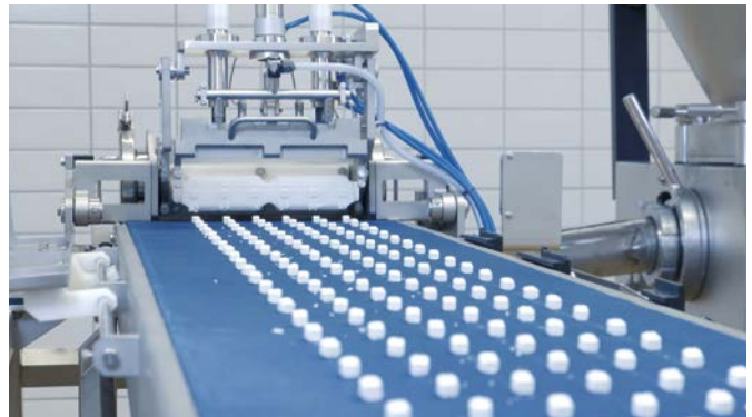
Auf bis zu 36 Bahnen sorgt VEMAGs FST883 für eine identische Aufteilung der Füllströme, z.B. für Frischkäse-Würfel oder -Taler.
