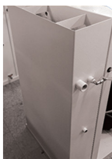
Depósito de recuperación de condensados
