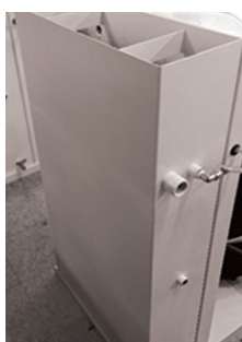
Depósito de recuperación de condensados
