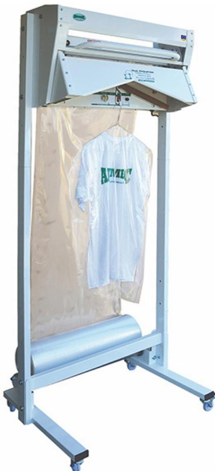
La embolsadora Artmecc Evolution PCL es una solución idónea para embolsar las prendas colgadas en percha. Activando los pulsadores neumáticos, bastan sólo dos segundos para que la bolsa quede confeccionada. Este modelo con bastidor y portarrollos facilita la carga de la bobina y la movilidad de la máquina
