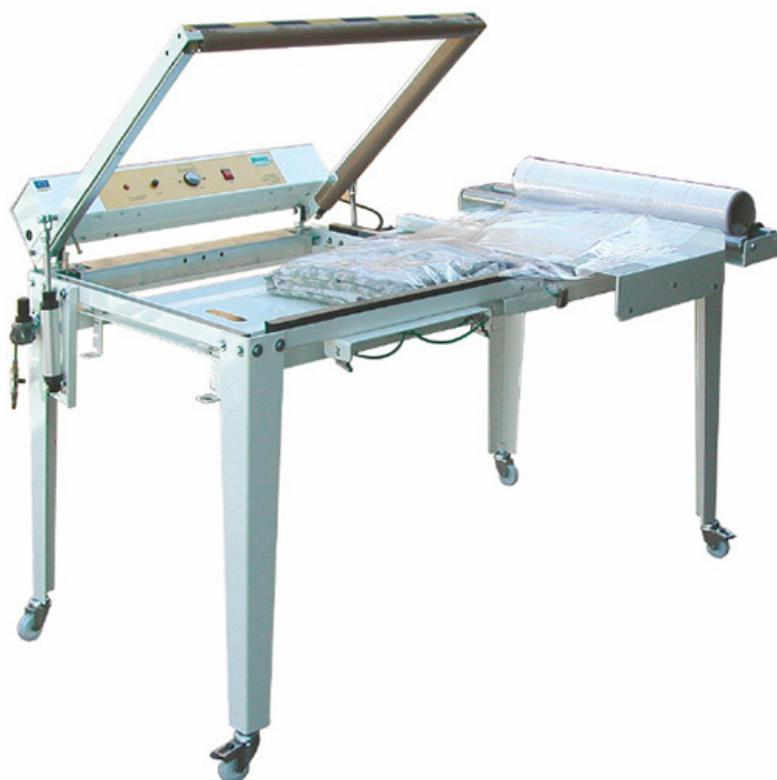
La embolsadora Artmecc NIB 08 neumática de soldadura en L se utiliza para empaquetar ropa plana de lavandería a partir de plástico en bobina de semitubo (abierto por un lado), pudiendo realizar paquetes con una altura de hasta 50 cm. El funcionamiento neumático se activa mediante la activación de dos pulsadores, lo que hace bajar el marco para realizar la soldadura y sube al presionar de nuevo los pulsadores una vez la bolsa ya está sellada.
