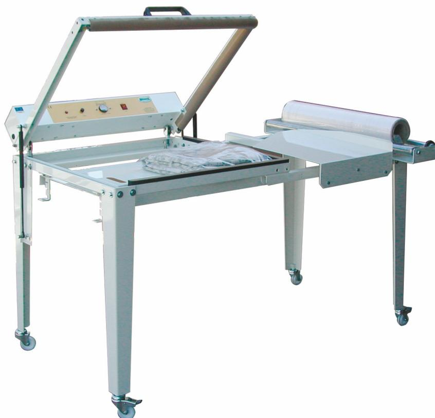
La embolsadora manual Artmecc NIB 08 de soldadura en L se utiliza para empaquetar ropa plana de lavandería a partir de plástico en bobina de semitubo (abierto por un lado), pudiendo realizar paquetes con una altura de hasta 50 cm
