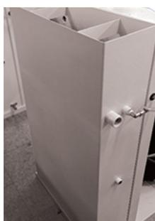
Depósito de recuperación de condensados
