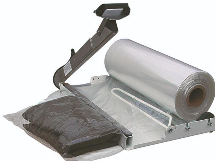
La selladora de guillotina con portarrollos Artmecc MLPB se utiliza para confeccionar bolsas a partir de plástico en bobina de semitubo (abierto por un lado), para entregar al cliente de manera rápida, eficaz y sin humos, con una simple presión durante 10 segundos sobre los lados abiertos de la bolsa
