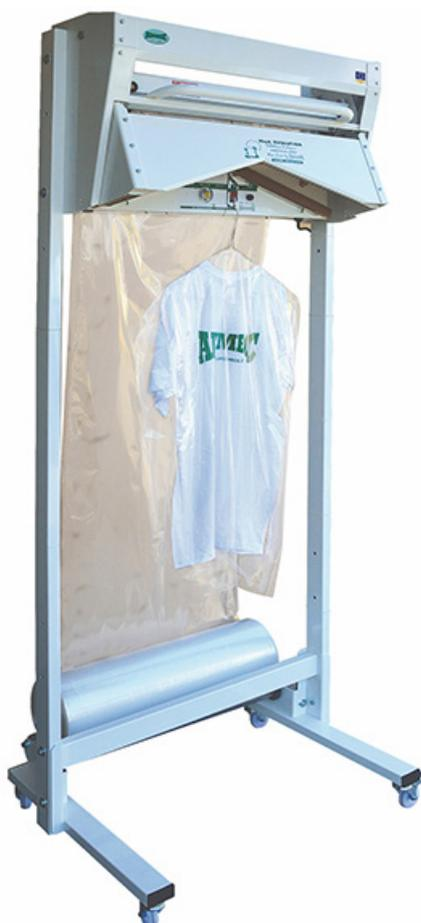
La embolsadora Artmecc Evolution es una solución idónea para embolsar las prendas colgadas en percha. Bajando manualmente el marco de soldadura, bastan sólo dos segundos para que la bolsa quede confeccionada. Este modelo con bastidor y portarrollos facilita la carga de la bobina y la movilidad de la máquina
