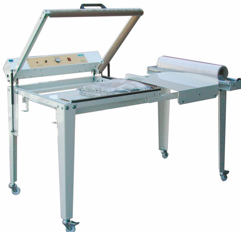
La embolsadora Artmecc NIB 08 neumática de soldadura en L se utiliza para empaquetar ropa plana de lavandería a partir de plástico en bobina de semitubo (abierto por un lado), pudiendo realizar paquetes con una altura de hasta 50 cm. El funcionamiento neumático se activa mediante la activación de dos pulsadores, lo que hace bajar el marco para realizar la soldadura y sube de manera automática cuando la bolsa ya está soldada
