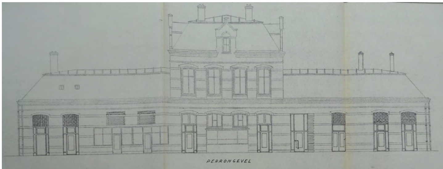
Afb. 2.4.11 Het ontwerp voor de perron gevel op de kaart bij het bestek van 3 maart 1960. In de vleugels worden alle oude bovenlichten boven de deuren dichtgemetseld. Er worden moderne deuren geplaatst. Detail van bestekstekening.
