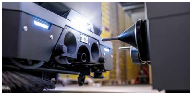
▲ Stacja dokująca zapewnia pełną autonomię – automatyczne uzupełnianie wody i ładowanie akumulatorów.
