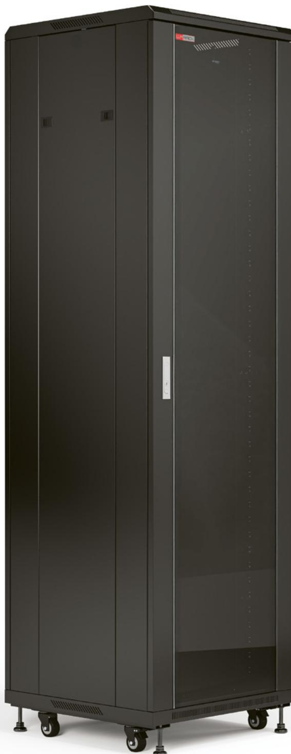
Armadi da pavimento 19" con porta frontale in vetro temperato (reversibile), completi di 4 montanti verniciati e numerati, aperture superiori e inferiori per l'ingresso dei cavi, 4 ruote (2 con freno) e 4 piedi di livellamento.
