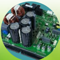
Unidad de inversor
