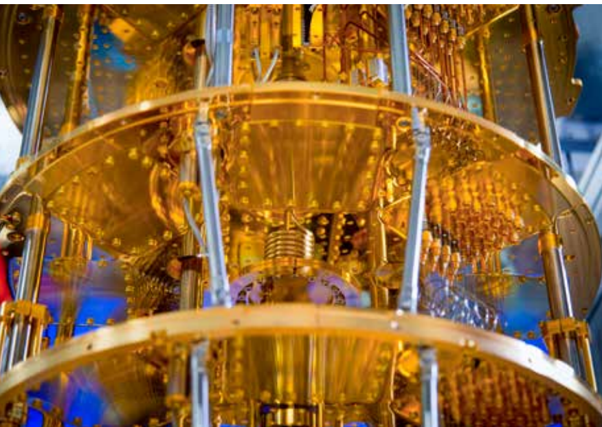
Wnętrze komputera kwantowego
