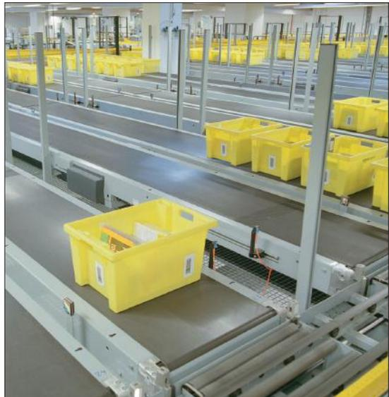
*Behälter mit verstärktem Boden in einem Versandzentrum für Bücher und CDs. (Foto: Vanderlande Industries.)*
