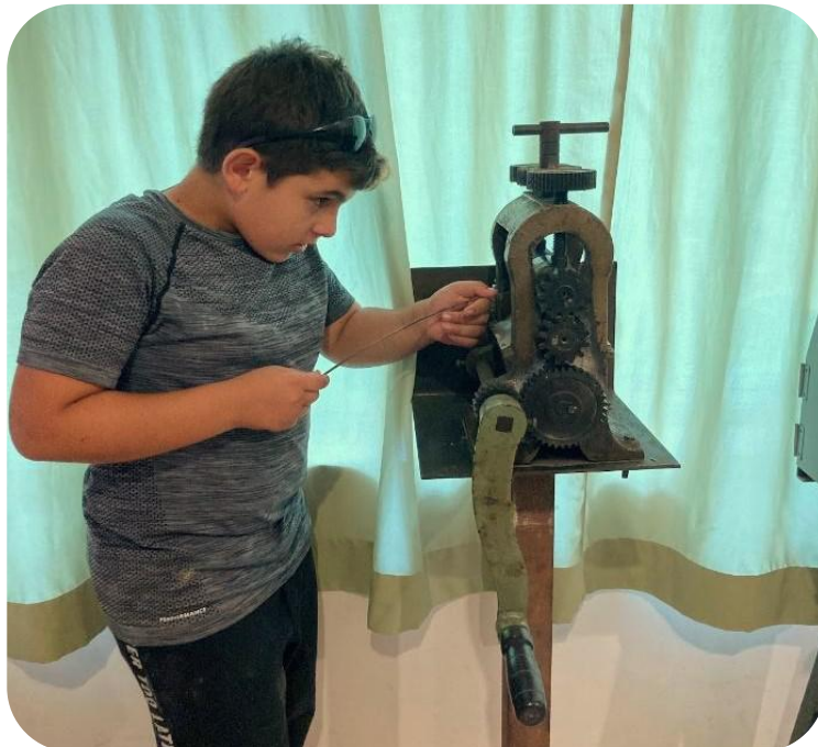
Laminação e fiação do metal.
