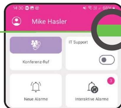
Der Benutzer sieht jederzeit den Verbindungsstatus der novaalert mobileAPP. Bei grünem Status ist sichergestellt, dass Alarme versendet und empfangen werden können.
